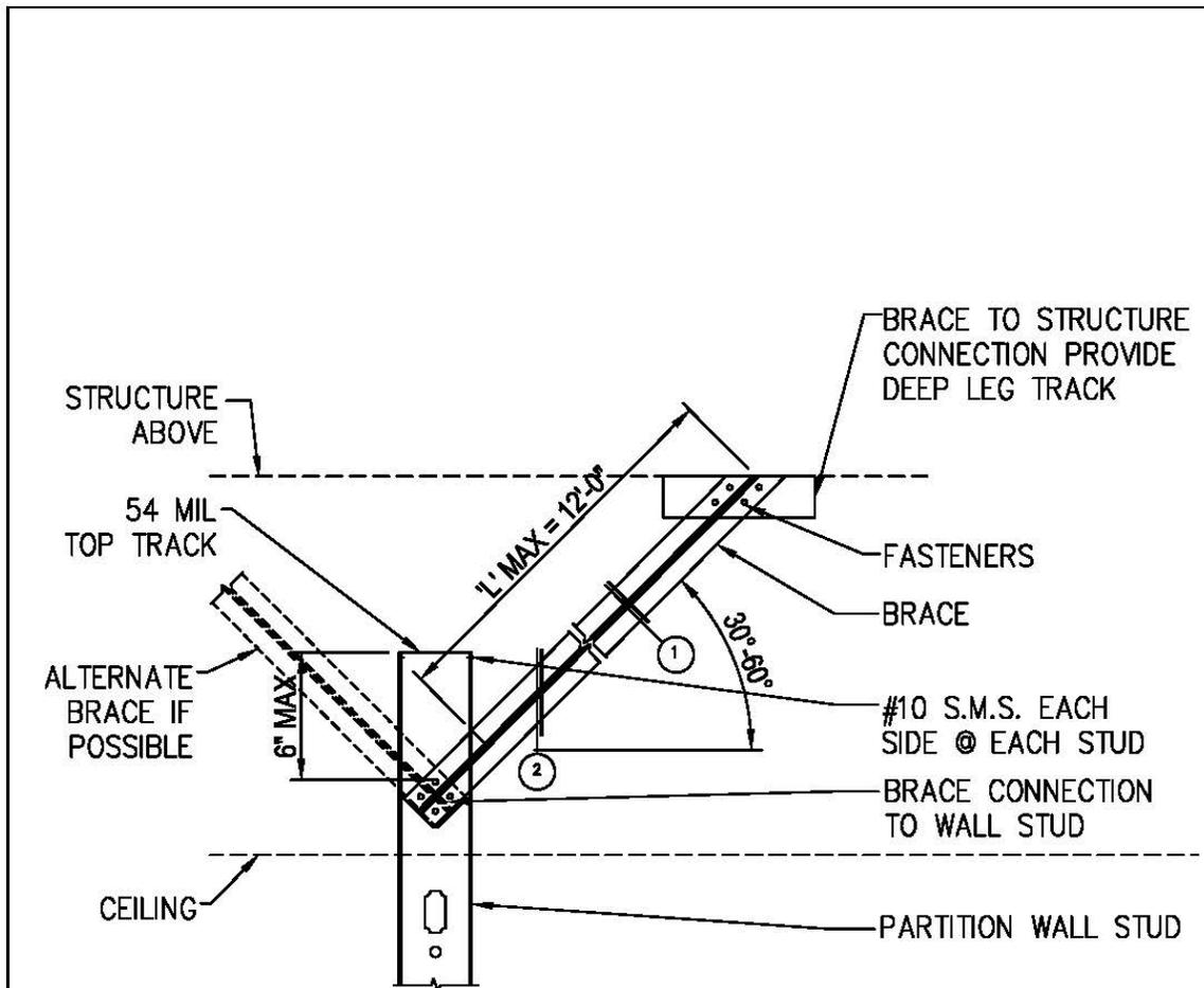
**TOP RESTRAINT AT PARTIAL HEIGHT PARTITION WALL**
