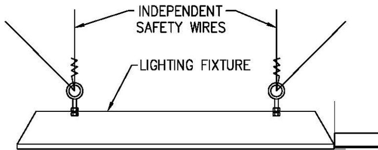
**18** TYPICAL RESTRAINT OF LIGHTING FIXTURE
