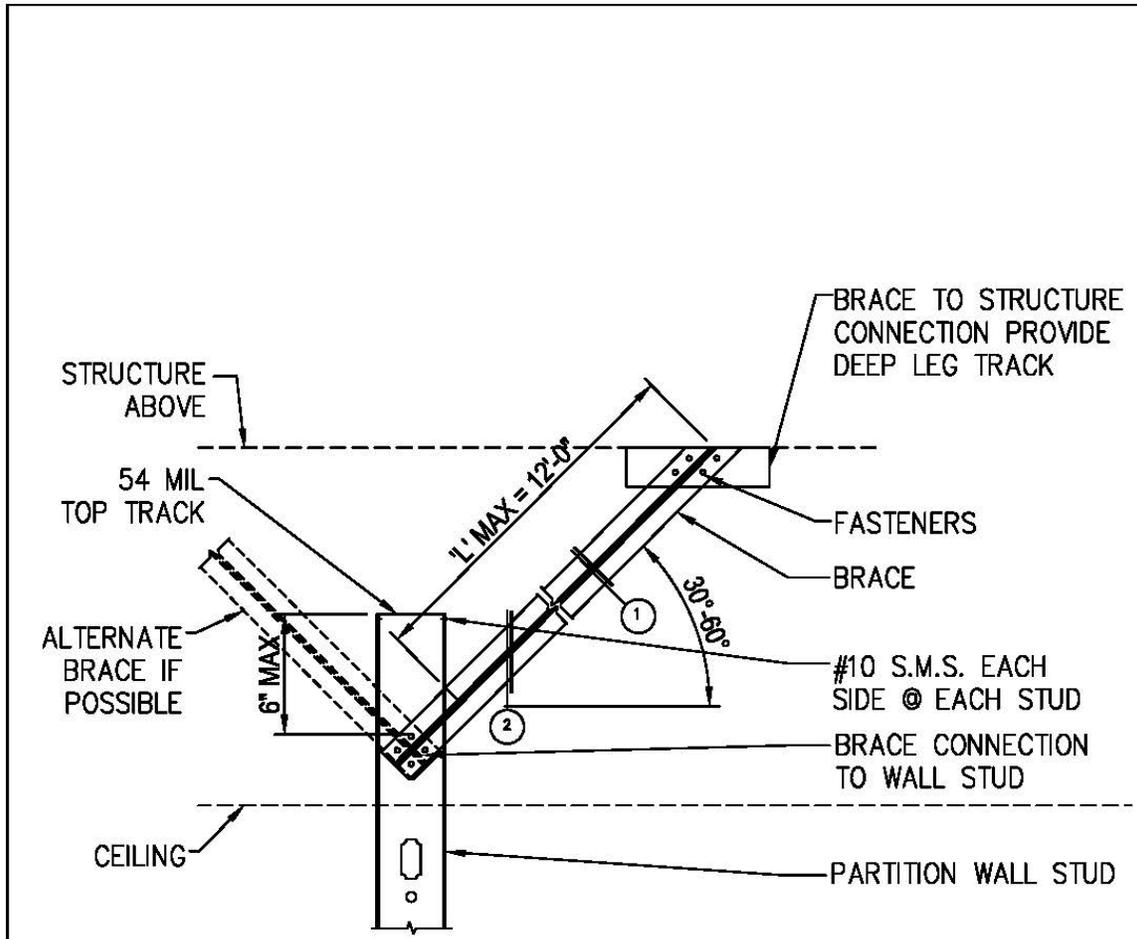
**TOP RESTRAINT AT PARTIAL HEIGHT PARTITION WALL**
